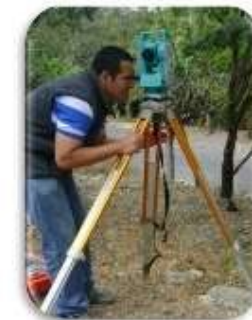
Fig. 14. con el ocular de la plomada óptica fije el punto de observación; dejando fija una de las patas y moviendo las otras dos hasta encontrar el punto.
