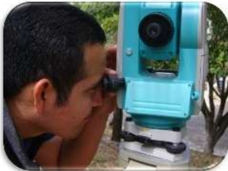
Fig. 13. Enfoque el Punto Topográfico mirando por el ocular de la plomada óptica, gire el ocular para enfocar el retículo, esto le permitirá ver claramente los círculos concéntricos del enfoque del objetivo (Reticulo).
