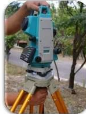
Fig. 12. Se coloca el instrumento sobre la cabeza del tripie, y sujetando con una mano al instrumento apriete el tornillo de fijación.
